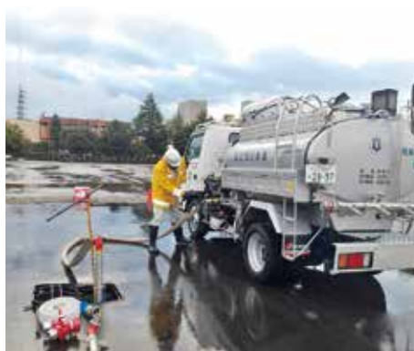
給水車への充水作業
